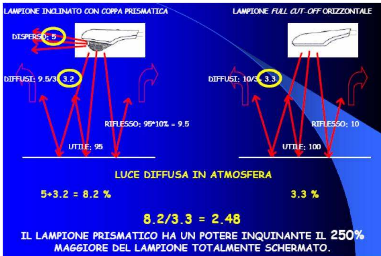
Fig. 39 – Differenza tra coppa prismatica e lampione cut-off
